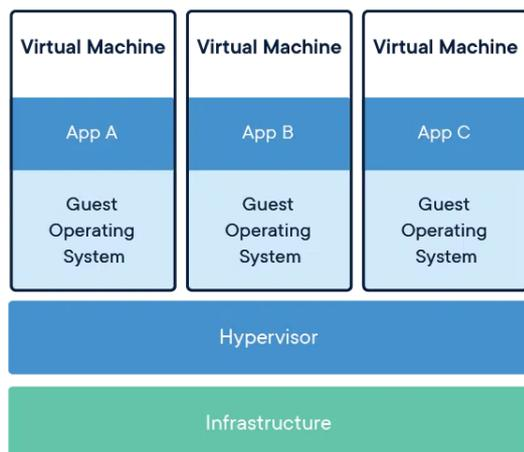
La virtualisation classique permet, via un hyperviseur, de simuler une ou plusieurs machines physiques, et de les exécuter sur le serveur hôte sous forme de machines virtuelles (VM). Ces VM intègrent elles-mêmes un système d'exploitation complet sur lequel les applications qu'elles contiennent sont exécutées.
